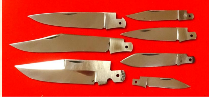
カスタムナイフメーカーの殆どは、熱処理は外注しておりますが、鹿山氏は全て形状・サイズに合わせて本人の手で処理しております。写真のナイフブレードは熱処理・磨き加工済ですが未刃付です。販売品有
